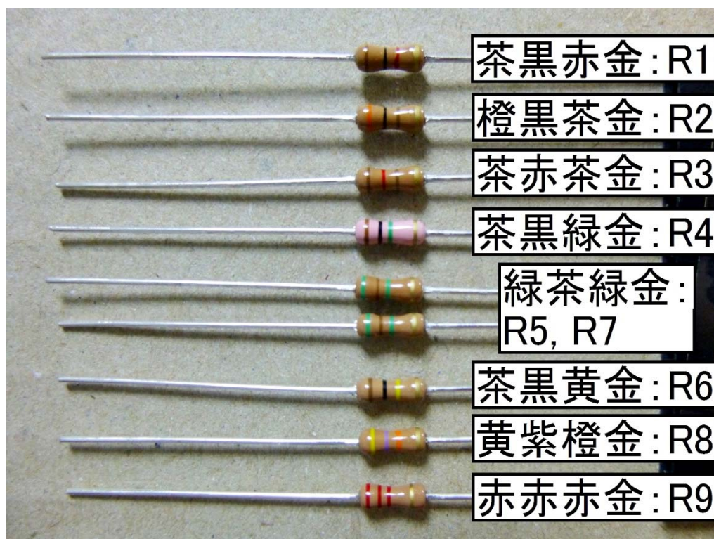
抵抗は、カラーコードで抵抗値を読み取り、部品番号を調べます。 (本写真をカラー表示で読むと判読しやすくなります)
